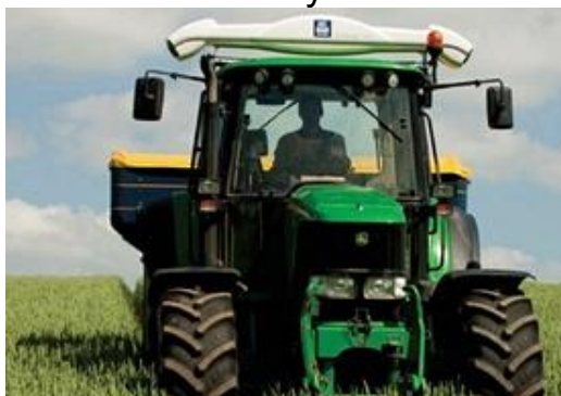
Рисунок 13.3 – Датчиковая система для определения доз азота YARA N-датчик
