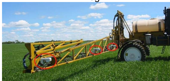
Рисунок 13.5 – Датчики GreenSeeker RT200
