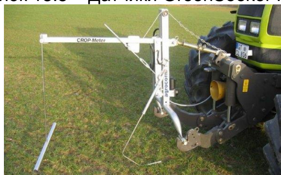
Рисунок 13.6 – Общий вид смонтированного на тракторе датчика Crop Meter
