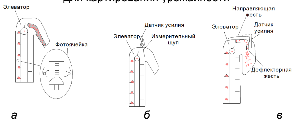
Рисунок 13.8 – Схема измерения объема проходящего зерна в элеваторе: а – фотоячейкой; б – измерительным щупом; в – отбойным щитком
