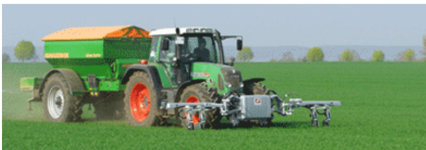
Рисунок 13.4 – Датчиковая система для определения доз азота MiniVeg N
