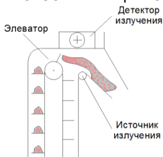
Рисунок 13.9 – Схема косвенного определения прохода зерна в зерновом элеваторе с помощью измерения гамма-лучей радиоактивного элемента в радиодетекторе
